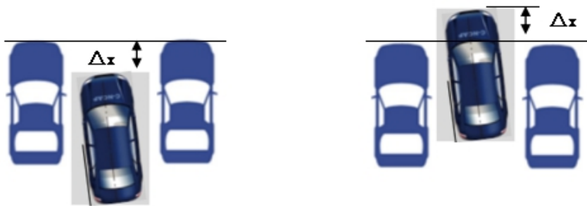
图 5-23-3 目标区域 \Delta x 示意图
