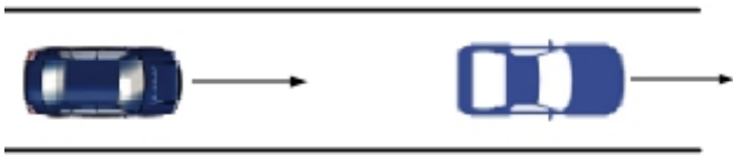
图 5-8 前车低速识别与响应测试场景示意图
