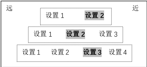
图5-5 跟车距离设置示意图
